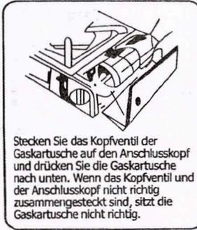
Stecken Sie das Kopfventil der Gaskartusche auf den Anschlusskopf und drücken Sie die Gaskartusche nach unten. Wenn das Kopfventil und der Anschlusskopf nicht richtig zusammengesteckt sind, sitzt die Gaskartusche nicht richtig.
