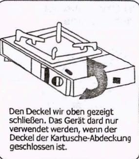
Den Deckel wie oben gezeigt schließen. Das Gerät darf nur verwendet werden, wenn der Deckel der Kartusche-Abdeckung geschlossen ist.
