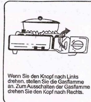
Wenn Sie den Knopf nach Links drehen, stellen Sie die Gasflamme an. Zum Ausschalten der Gasflamme drehen Sie den Kopf nach Rechts.
